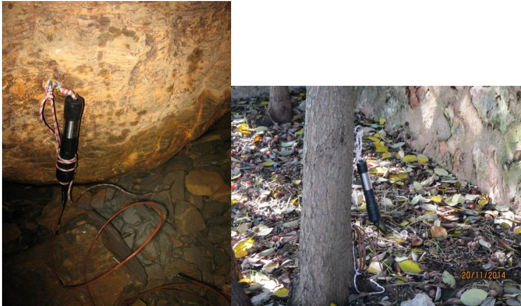
Figura 1. A la izquierda sensor instalado en el manantial de Zarzalones, sensor principal midiendo temperatura del aire y sensor secundario sumergido. A la derecha, sensor de temperatura ambiente en Son Mir (Mallorca)
